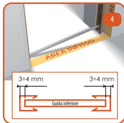
4 Controllare che la guida a terra sia circa 8 mm più corta dello spazio interno fra le 2 guide laterali. Togliere il biadesivo e posizionare la guida a terra in asse con quanto già montato e centrata fra le 2 guide laterali.
