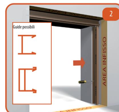
2 Posizionare e fissare le guide laterali, quella con le clips ospita il cassonetto. *Nel caso di centrali entrambe hanno le clip.*
