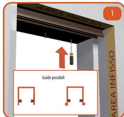
1 Posizionare la guida superiore, se è presente un solo labbro rivolgerlo verso l'infisso e fissare la guida con le viti.
