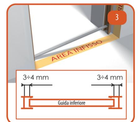
3 Togliere il biadesivo e posizionare la guida a terra in asse con quanto già montato.
